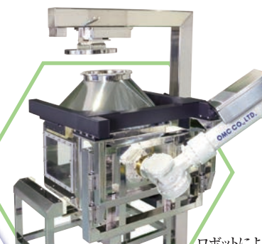
ロボットによる コンテナ容器の蓋の 自動脱着
